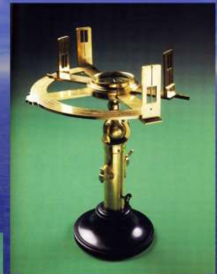
Graphometer oder geodätisches Astrolab um 1700
