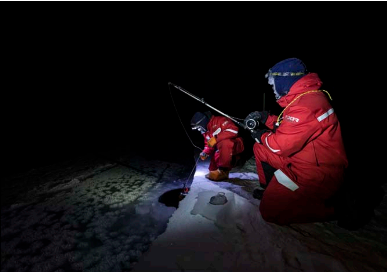
Messung mit der Mikrostruktursonde an einem frisch aufgebrochenen Riss im Eis. 23.01.2020, 87°27'N & 94°13'E, 283 km zum Pol.
